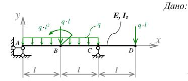
: Шарнирно опёртая балка постоянной жёсткости нагружена распределённой силой q, силами  $q \cdot l$  и моментом  $q \cdot l^2$ .
